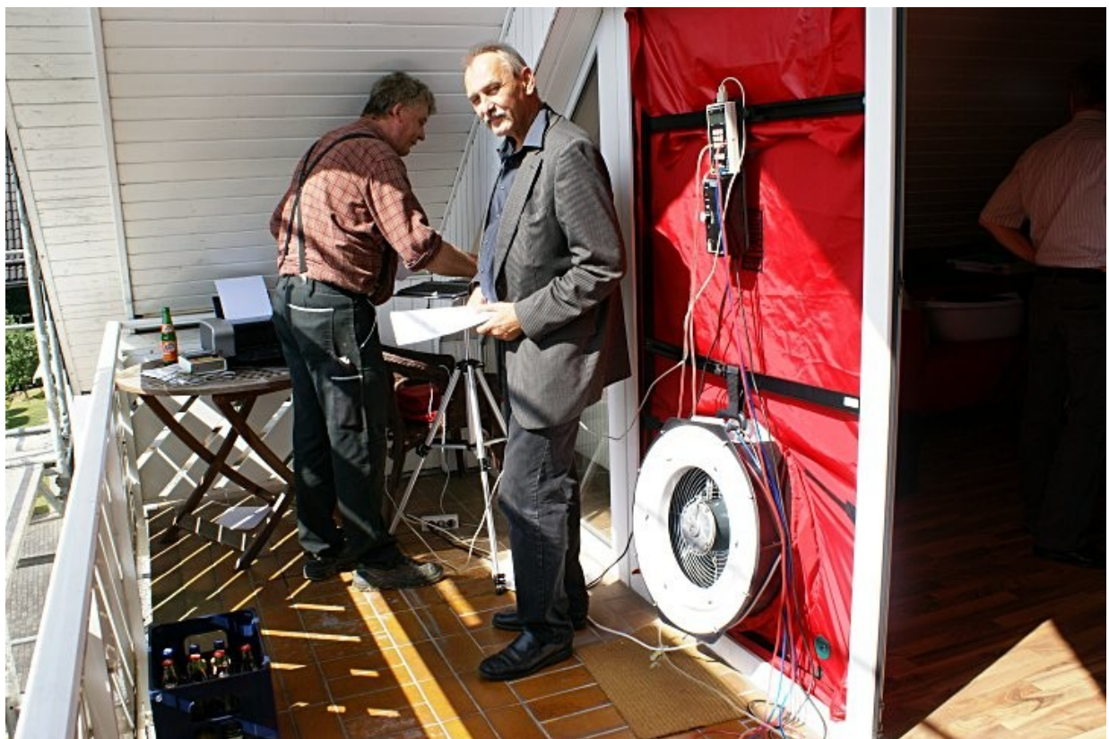
Ullrich Hegner (re.) und Joachim Weil verfolgen neben der Blower-Door, der Tür mit der Turbine, die Messungen.
